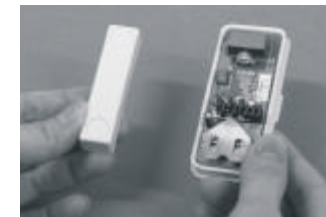
Lorsque le détecteur ne détecte plus de contact magnétique, le récepteur émettra un signal sonore et un DEL rouge clignotera.
