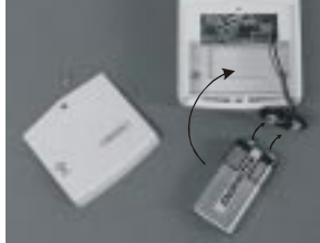
Insérez une pile alcaline 9V dans le détecteur
